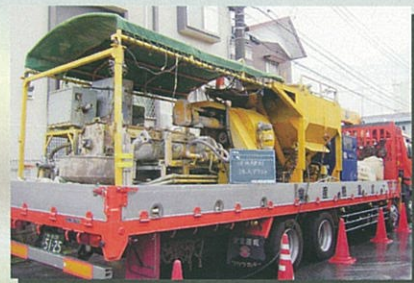
注入プラント車
